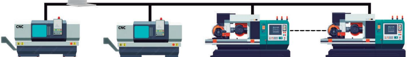
A solução **teepDNC - Manager**, desenvolvida pela Teep Tecnologia, é um **gestor do fluxo de programas** entre o sistema CAM, um servidor ou computador, que armazena os programas NC, o controlador CNC, o operador da máquina e o programador responsável pelo processo de fabricação como um todo.
